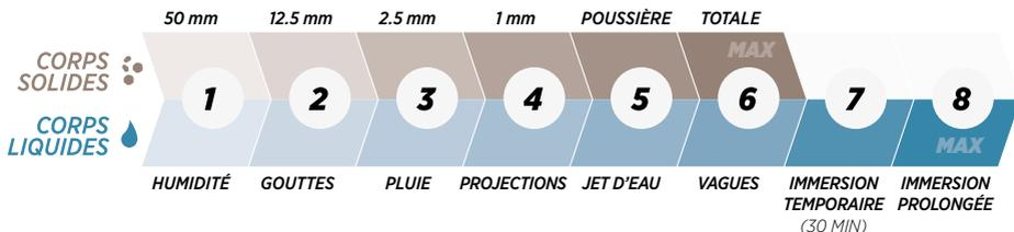
RÉSISTANCE TOTALE AUX CORPS SOLIDES | **IP68** | RÉSISTANCE À L'IMMERSION PERMANENTE
